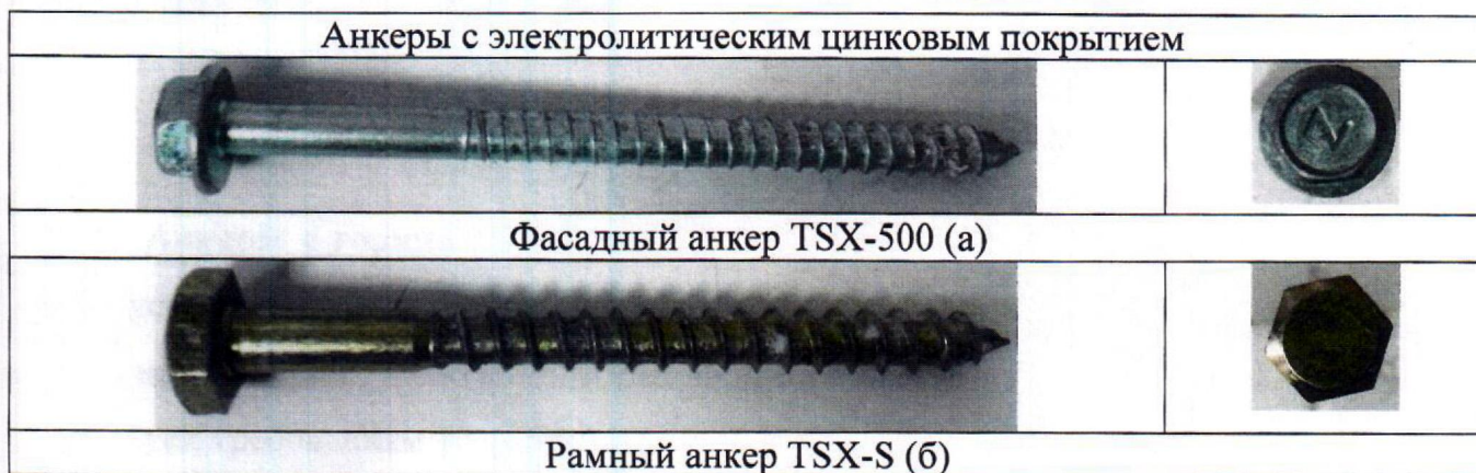
Рис. 2. Внешний вид анкеров с гальваническим цинковым покрытием с голубой (а) и радужной (б) пассивацией после испытаний в камере влажности.
