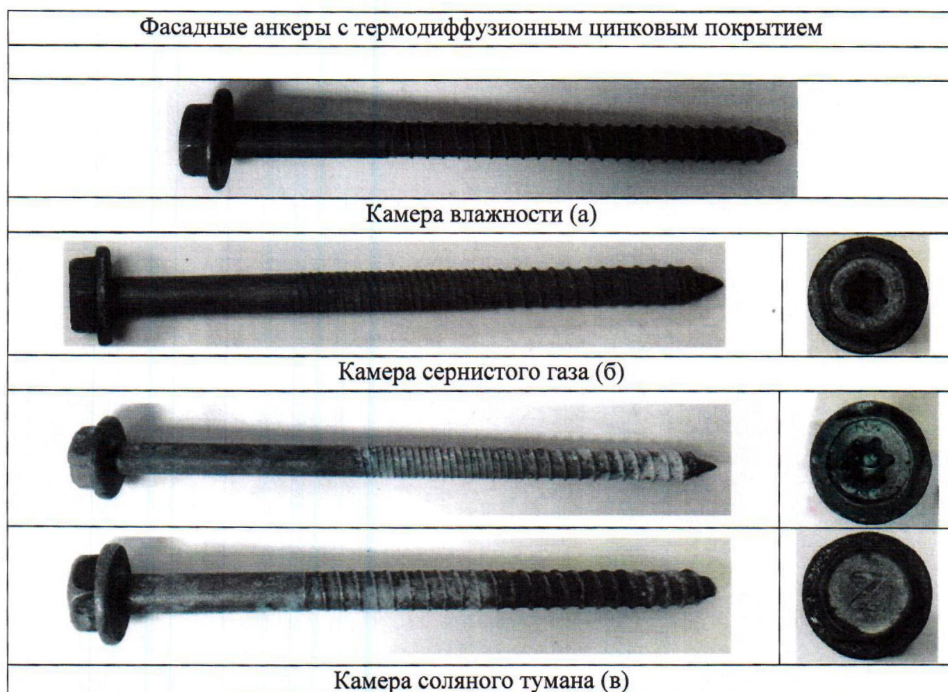
Рис. 6. Внешний вид анкеров с термодиффузионным цинковым покрытием после испытаний в камерах влажности (а), сернистого газа (б) и соляного тумана (в).
