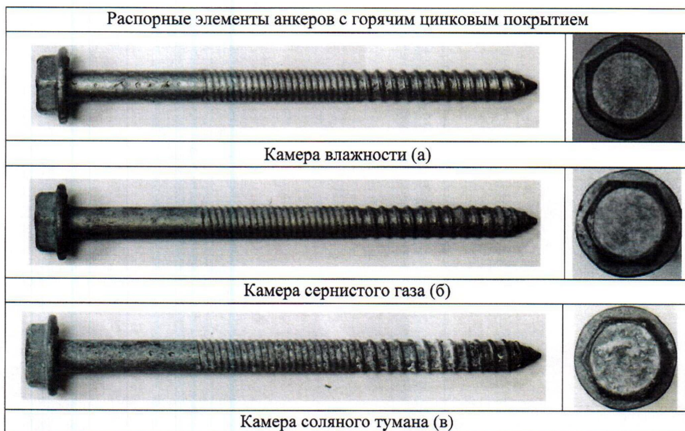
Рис. 4. Внешний вид распорных элементов анкеров с горячим цинковым покрытием после испытаний в камерах влажности (а), сернистого газа (б) и соляного тумана (в).
