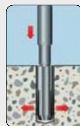
Выполнить анкерровку при помощи оправки
