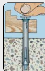
Установить декоративную крышку
