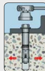
Затянуть анкер необходимым моментом затяжки
